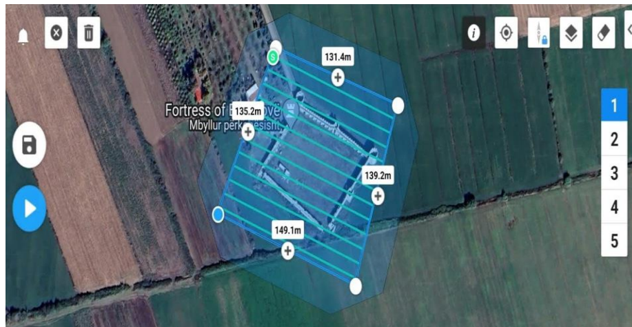
Figura 21 - Planifikimi i misonit oblik me 5 misione të ndryshme
