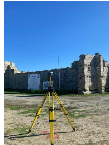
Figura 14 - Pajisja GNSS gjatë procesit të matjeve
