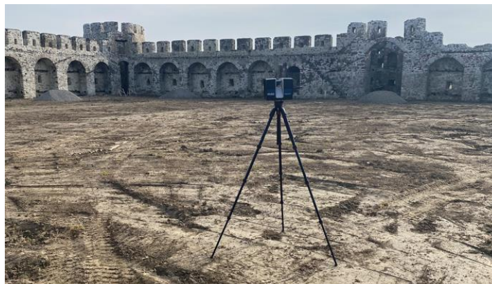
Figura 22 - Skanimi me Faro Focus S70 i kalasë
