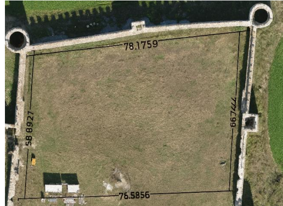
Figura 13 - Skema e perimetrit të kalasë me dimensione kryesore.
