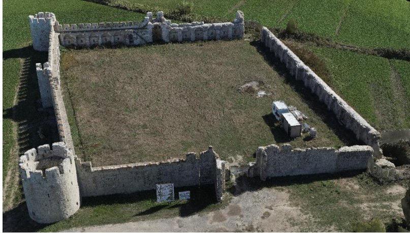
Figura 30 - Modeli tridimensional i unifikuar nga FARO Focus S70, Leica BLK360 G1 dhe GoSLAM RS100i
