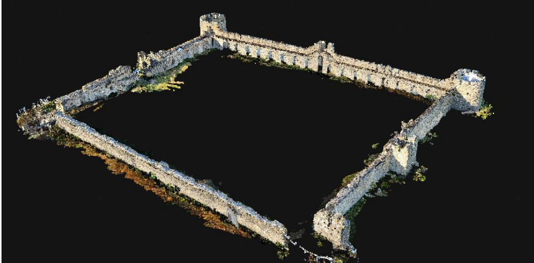
Figura 31 - Integrimi i re-së së pikave nga iPhone LiDAR me modelin TLS në CloudCompare
