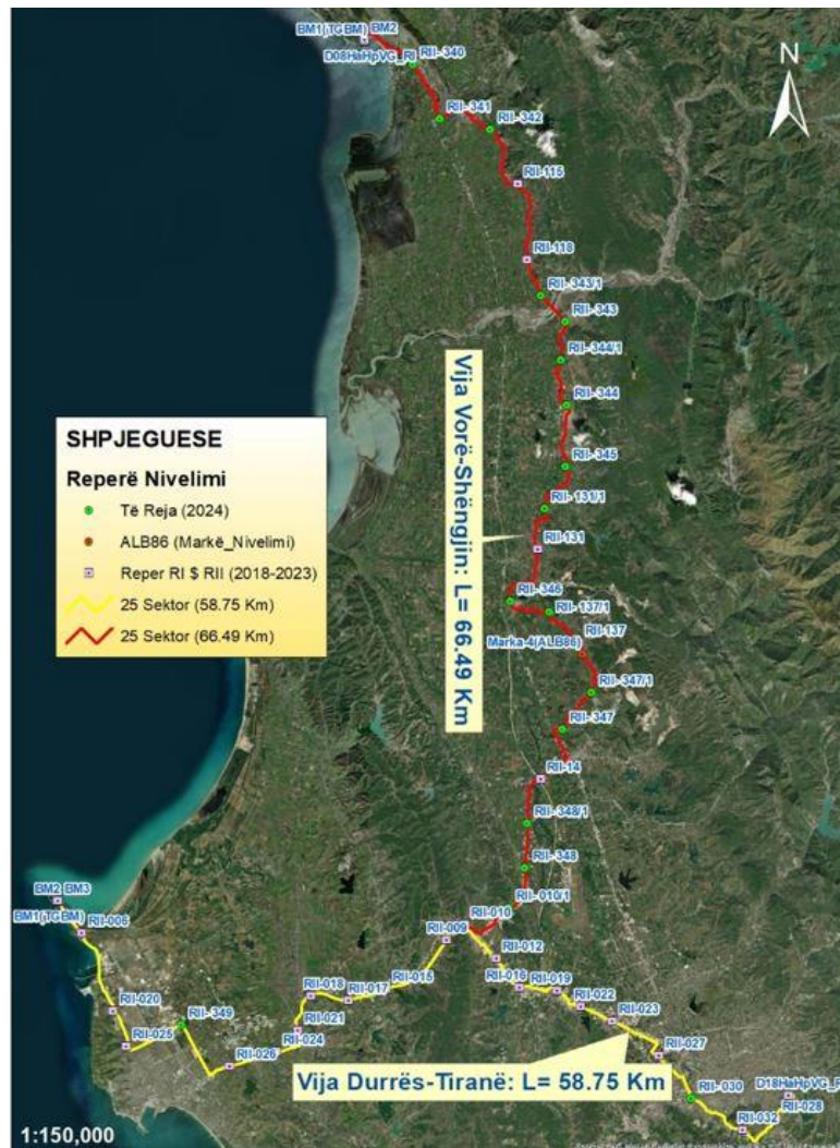
Figura 46 - Skema e vijave të nivelimit të rendit të parë.
