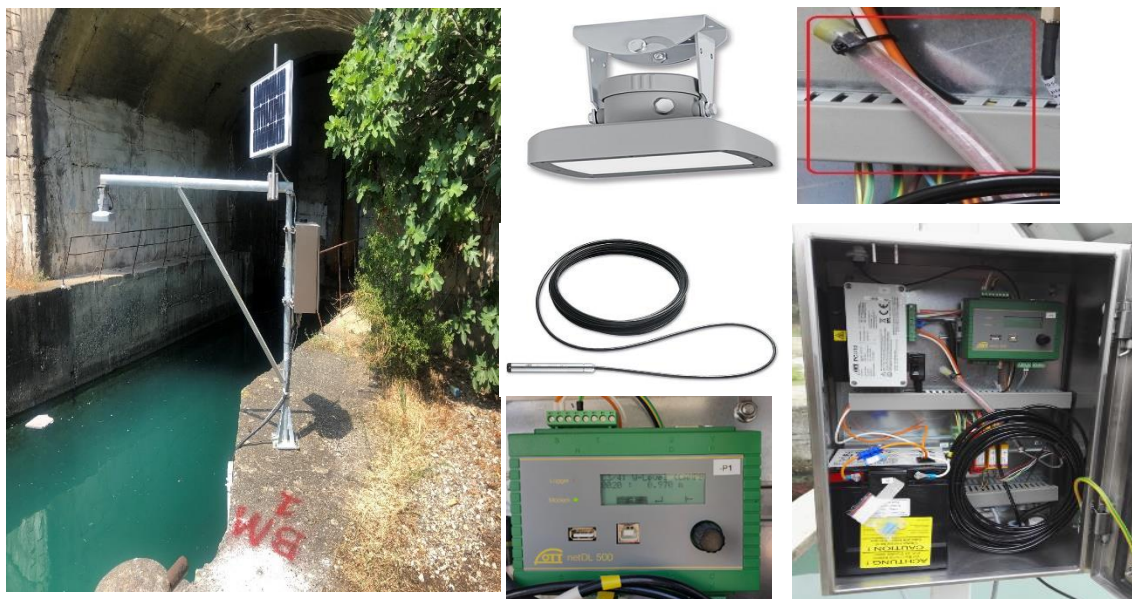
Figura 5 - Baticëmatësi i Shëngjinit dhe paisjet e një stacioni.
