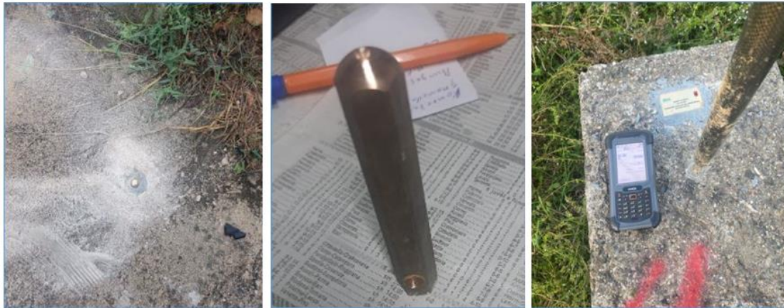
Figura 45 – Reperët e nivelimit të rendit të I të nivelimit.
