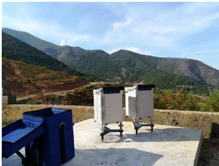
Figura 17 - Pamje nga matjet fushore gravimetrike të rendit të I, me dy gravimetra të vendosur pranë njëri tjetrit.
