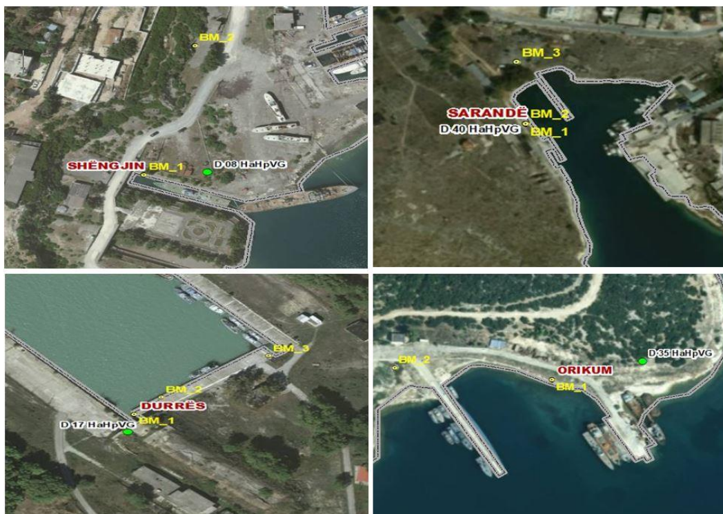
Figura 32 - Skema e ndërtimit të mikro-rrjetit në katër stacionet baticë-matëse.
